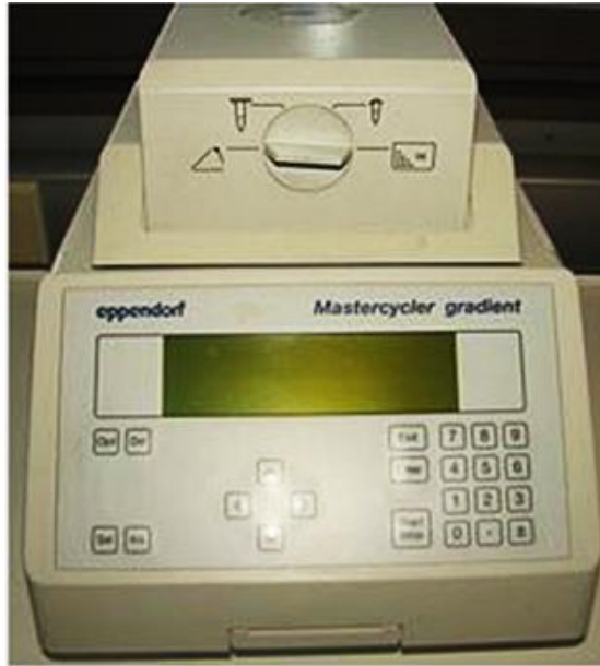
Рисунок 2.9 – Амплификатор для проведения полимеразной цепной реакции
